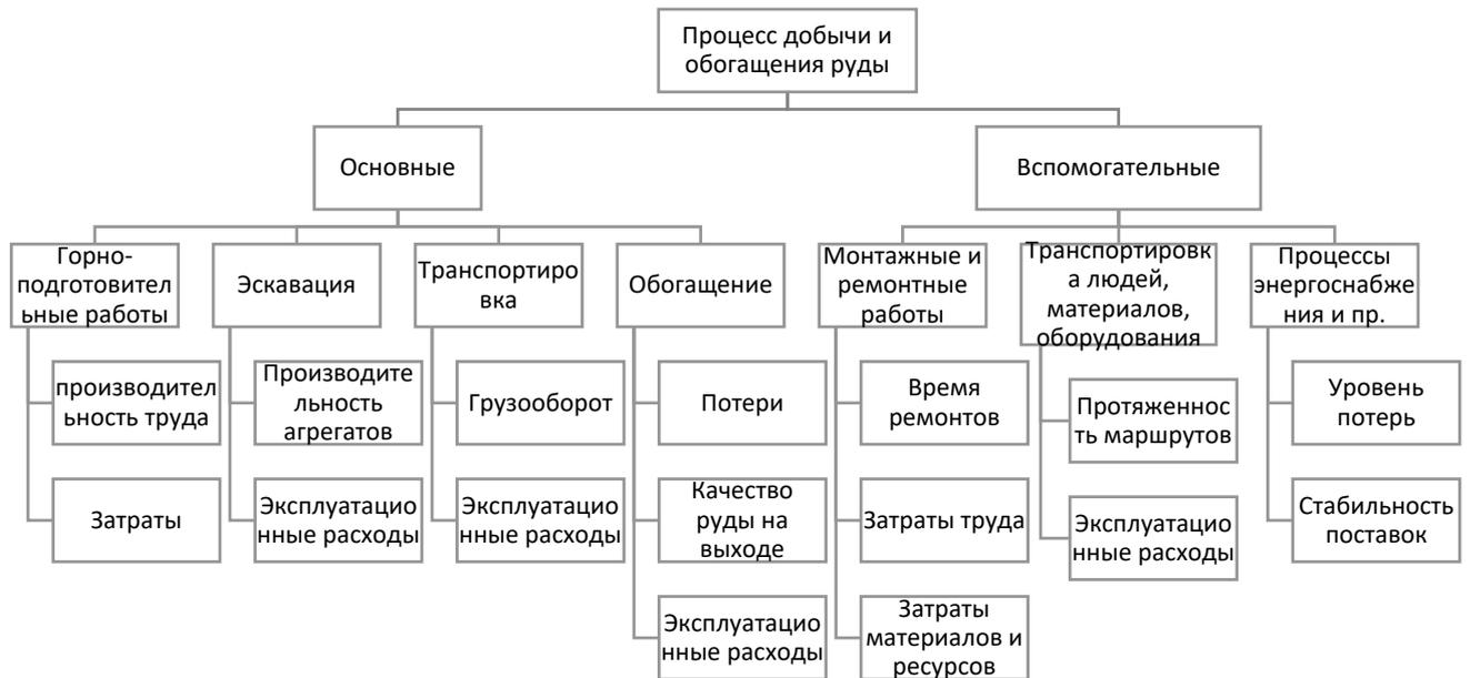
Рис. 2.6. Процесс формирования основных технико-экономических показателей в процессе производства обогащенной асбестовой руды
