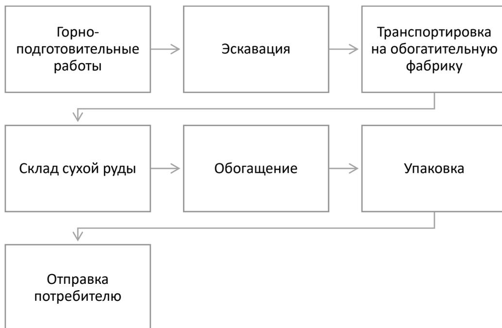
Рис. 2.5. Технологический процесс добычи хризолита
